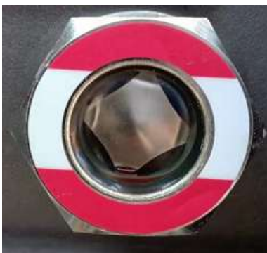
Figura 2.2 Diagrama esquemático del nivel de aceite por debajo del límite inferior de la mirilla de aceite
