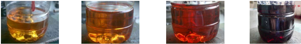
Figura 2.5 Diagrama esquemático del cambio de color del aceite lubricante
