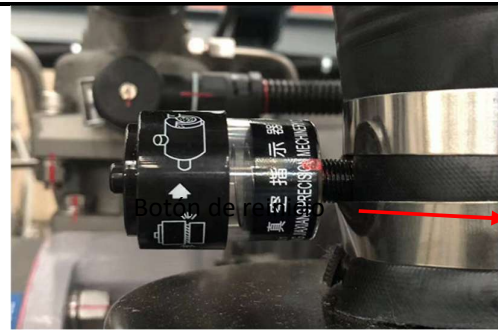
Figura 3.1 Diagrama esquemático del indicador de vacío
